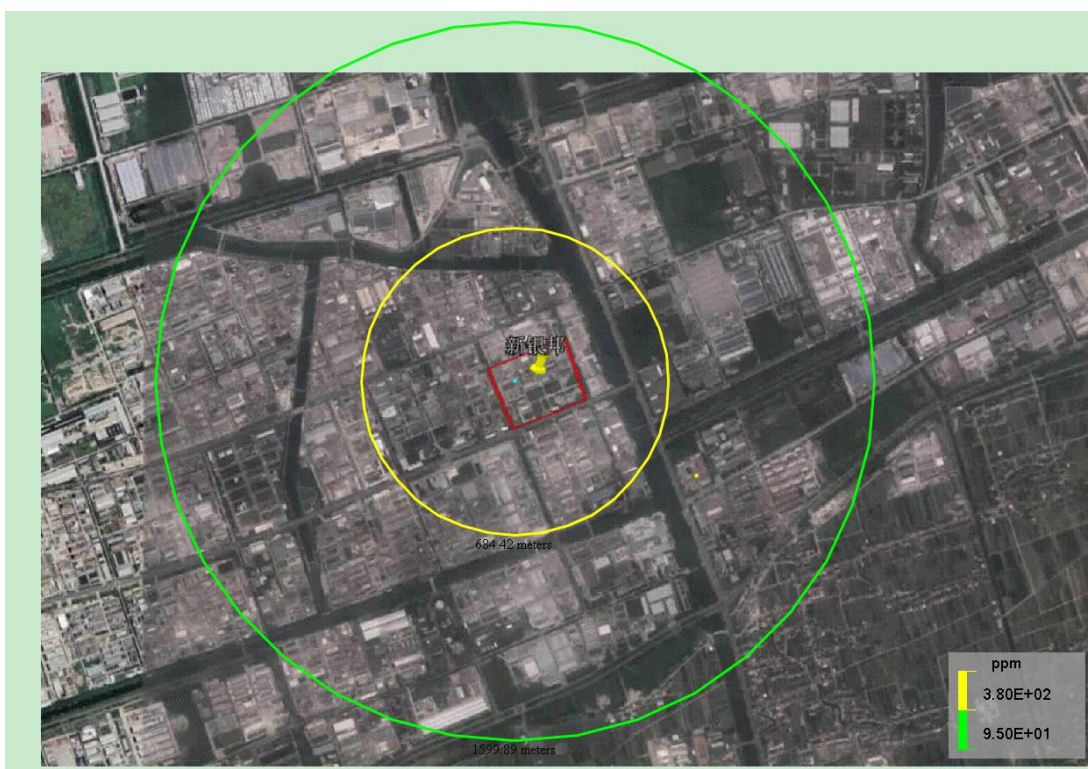
图 7.4-10 甲苯泄露火灾事故伴生/次生污染物 CO 预测结果（最不利气象条件下）
